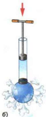
Рис. 100. Передача давления во все стороны без изменений: а — жидкостями; б — газами
