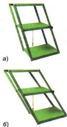
Рис. 190. Равновесие призмы на шарнирах: a — устойчивое; б — неустойчивое
